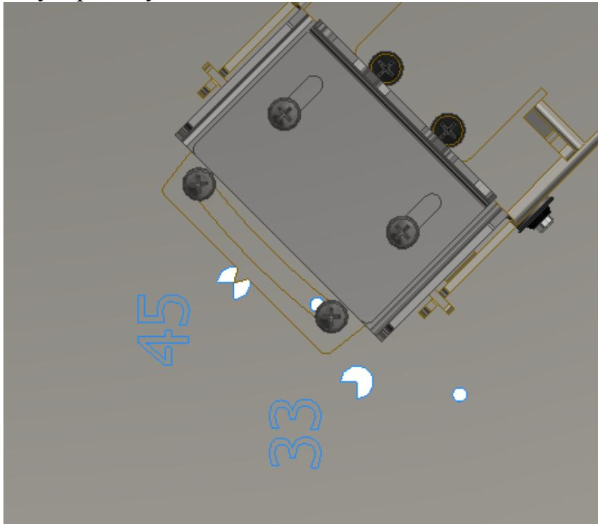
Ослабить винты крепления ложемента к основанию. Совместить стрелку ложемента с требуемым обозначением угла. Затянуть винты.
