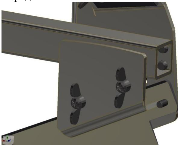
Ослабить крепежные винты - барашки. Снять нож. Установка в обратной последовательности.
