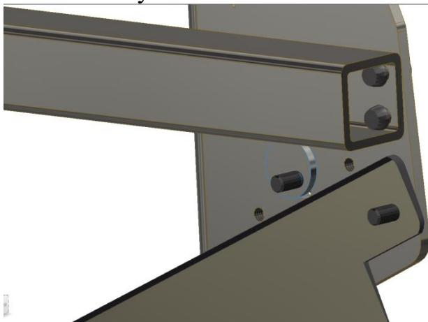
Повернуть эксцентриковую шайбу до упора в лезвие ножа.
