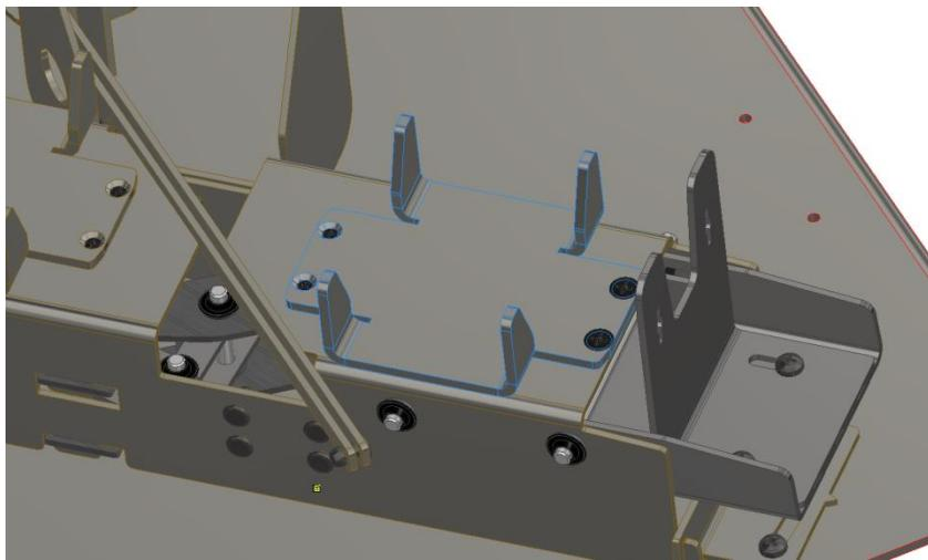
Выкрутить винты крепления лотков к ложементу. Установить требуемые по размеру лотки. Закрепить их винтами.
